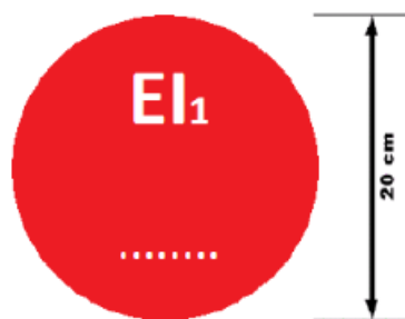
Figuur 3: Label branddeur/-poort: aanduiding brandweerstand.
